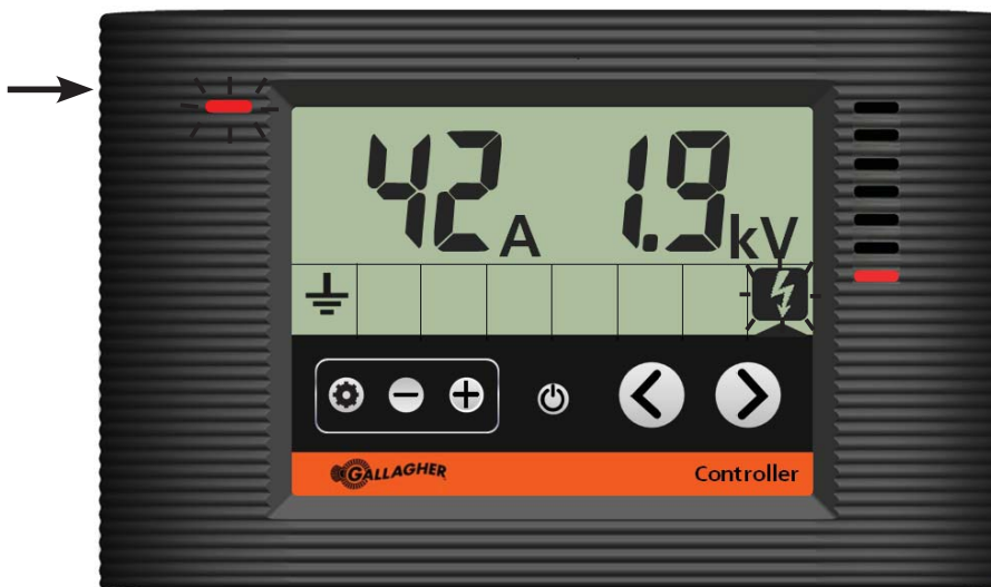
Controlador mostrando el energizador con alarma de corriente
