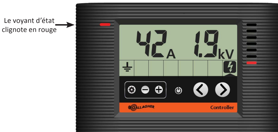
Contrôleur montrant l'électrificateur en état d'alarme
